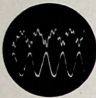
50 Hz. en 50 + 350 Hz. gelijktijdig afgebeeld; tijdbasis ong. 200 Hz.
