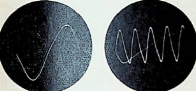
Lichtnet freq. 50 Hz. met tijdbasis 50 Hz. Frequentie 1000 Hz. met tijdbasis 200 Hz.
