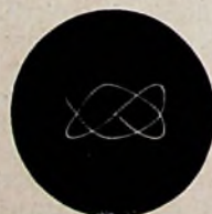
Figuur van Lissajous. Tijdbasis lichtnet wisselspanning
